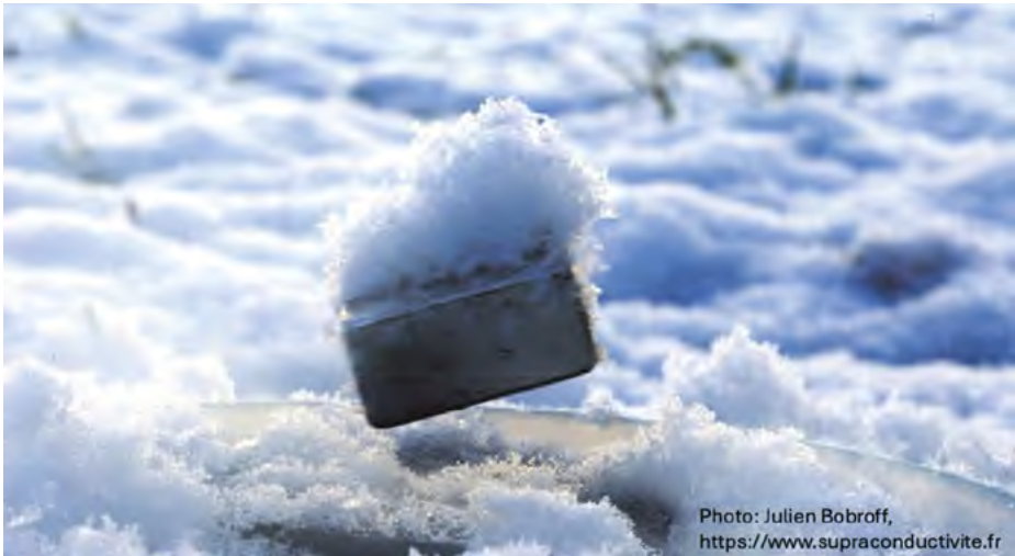
Abb. 1: Das Schweben eines Supraleiters – eine magnetische Eigenschaft von zentraler Bedeutung für neue Magneten, Elektromotoren und zahlreiche weitere Anwendungen – ist eine direkte Konsequenz seiner makroskopischen Quantenkohärenz.
