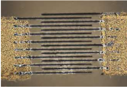
Gedruckte Interdigital-Kapazität (Linienbreite und -abstand je 8\mu\text{m} ) für ultra-breitbandige DC-Blocks (siehe [3])
