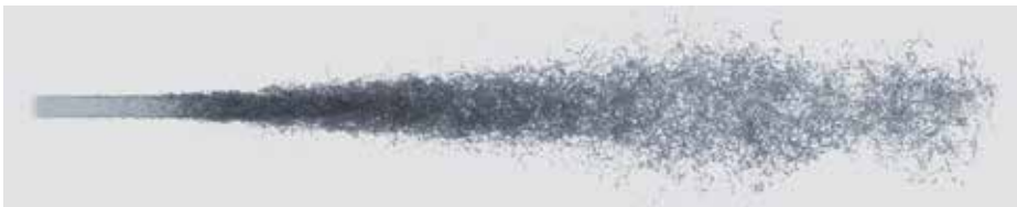
Abb. 3: Zerfall eines Flüssigkeitsstrahls
